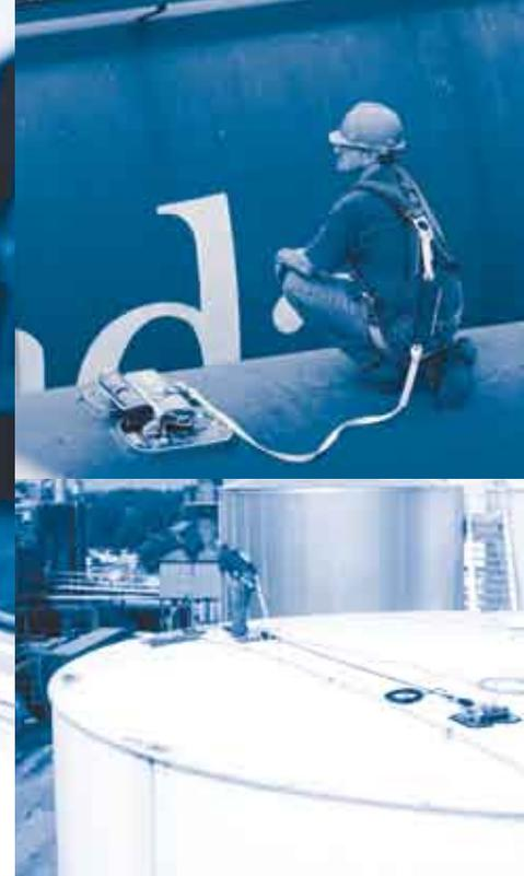
Unabhängiges anschlagssystem vacUUm anchor (scva)
